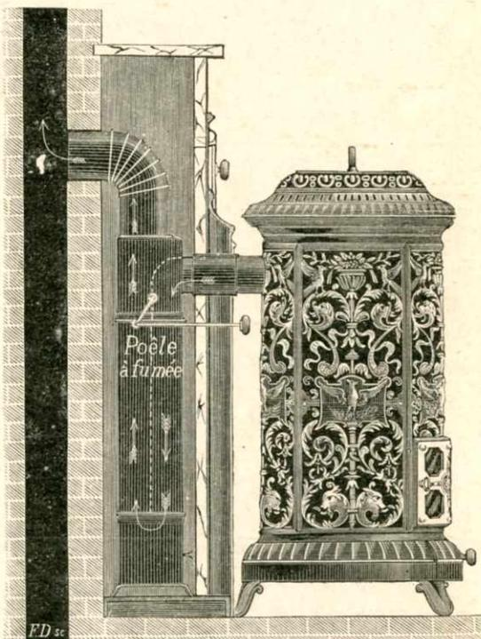
**VUE PAR COTÉ** laissant voir le poêle à fumée et son montage à l'intérieur de la cheminée. Suivant les flèches on se rend compte de la circulation de la fumée.
